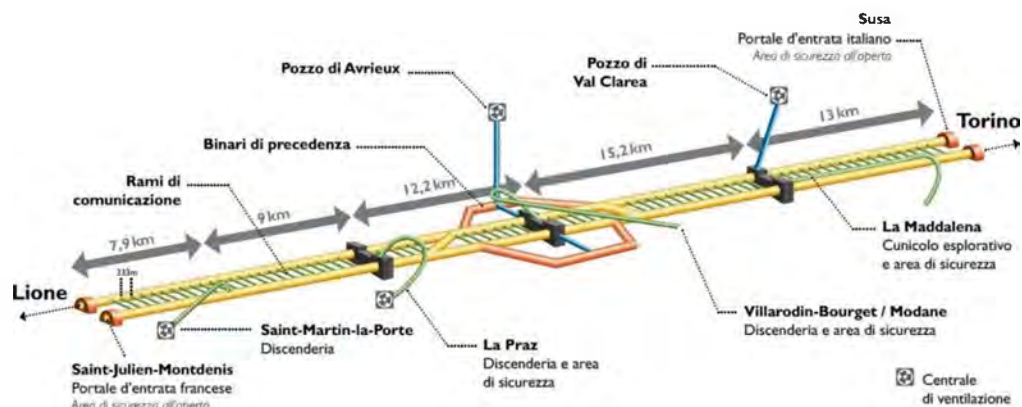
Figura 3 - Schema del Tunnel di Base di 57,5 km e delle principali opere connesse
