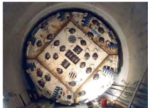
Figura 4- Gea, la TBM del Cunicolo Geognostico della Maddalena
