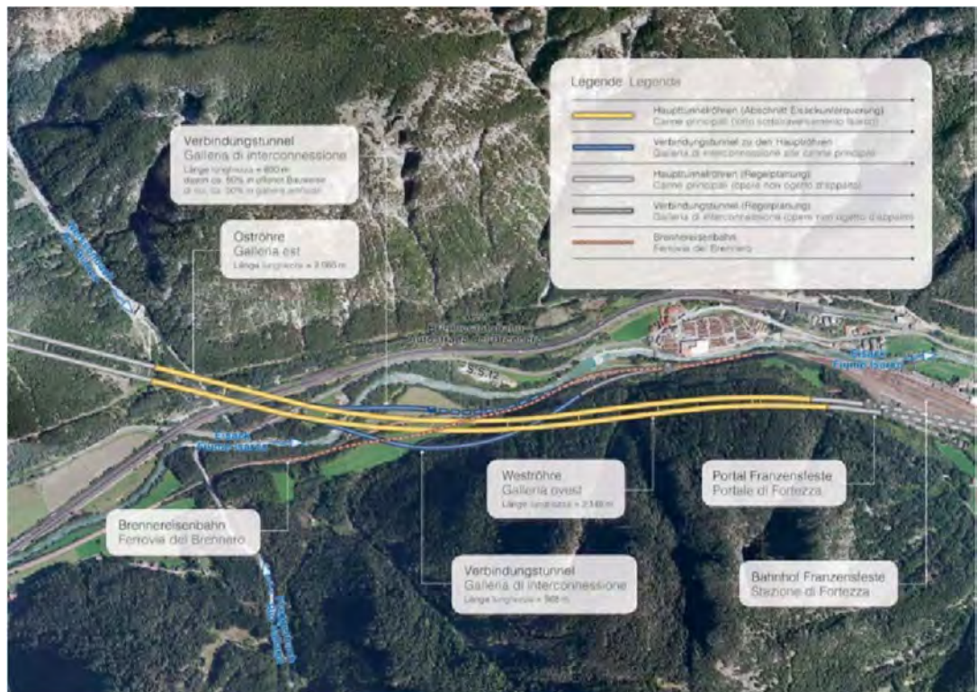
Il tracciato del Sottoattraversamento Isarco, il secondo dei due grandi lotti costruttivi in corso di realizzazione in Italia.
