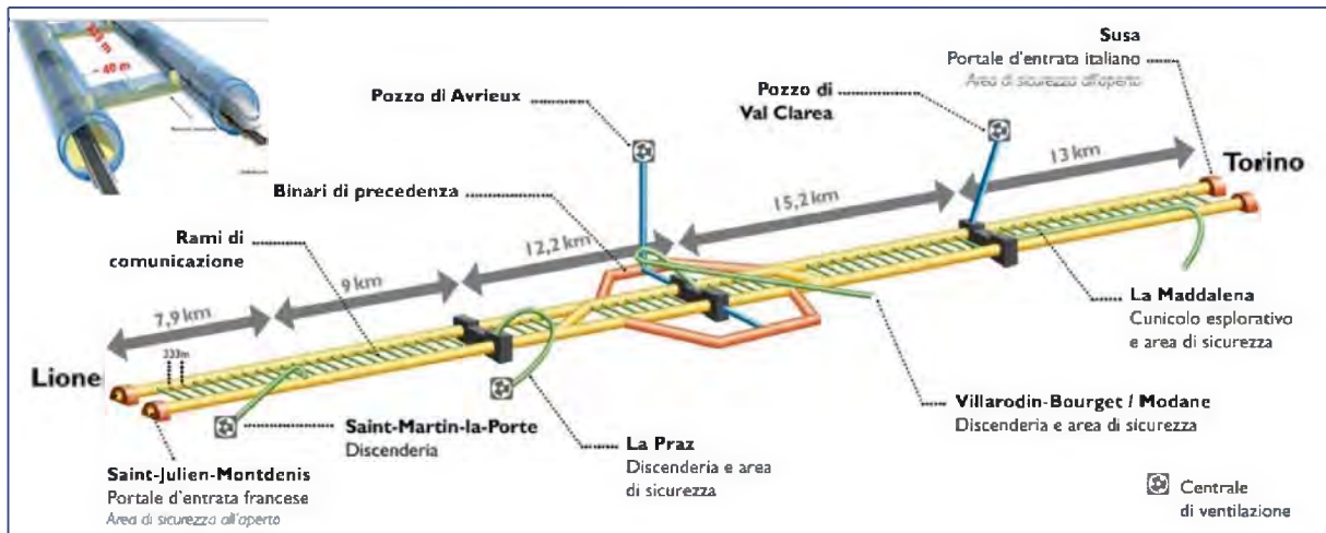
Fig. 3 – Rappresentazione schematica del sistema galleria
