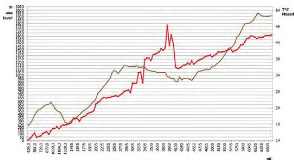
Figura 7- Curva rossa andamento della temperatura dell'ammasso, curva marrone copertura della topografia in relazione all'avanzamento dello scavo (progressive, pK sull'asse delle ascisse)
