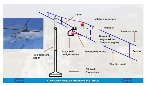
Obiettivo del corso proposto dal CIFI è fornire conoscenze generale del sottositema Energia, ed in modo particolare del **sistema della catenaria**, che distribuisce l'energia elettrica ai treni che circolano sulla linea e la trasmette ai treni per mezzo di dispositivi di captazione di corrente:
